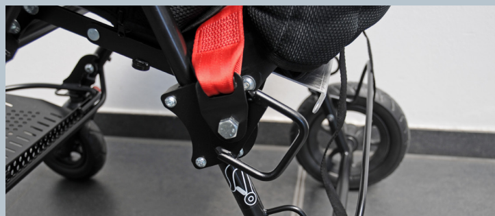
Zwei hintere Kraftknotensysteme mit jeweils einer Leichtbauöse für Spannretractor. Der Beckengurt ist bereits fest montiert.
